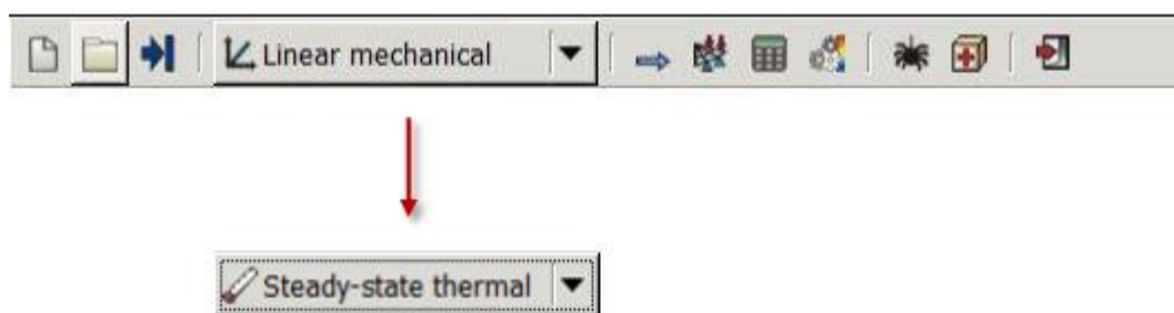
Rysunek 1: Zmień tryb z "Linear mechanical" na "Steady-state thermal"
